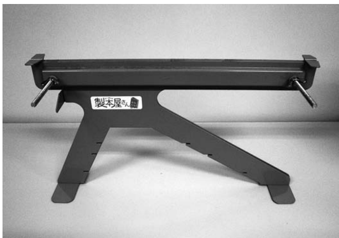
図2 くるみ製本機「製本屋さん」 ※厚めの本を製本するために，ネジを長めのものに変更
